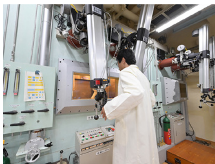
固体のRIを合成する際はマニピュレータを使用
