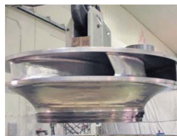
4 ポンプ水車は、水の力で回転子を回して発電し、揚水時は回転子の力で反対方向に回してポンプとなって水を汲み上げる。
