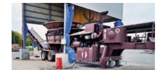
貯木場で木材をチップ化する大馬力の加工機(チップパー)
