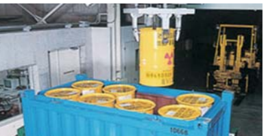
原子力発電所にて輸送容器に収納されるドラム缶 出典:原燃輸送株式会社HP 低レベル放射性廃棄物 輸送の概要
