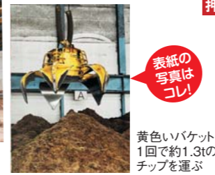
貯木場で木材をチップ化する大馬力の加工機(チップパー)
