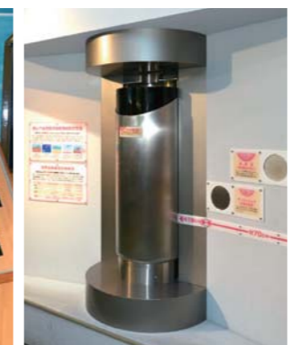
高レベル放射性廃棄物を地層処分するためのガラス固化体の模型。来館者から多くの質問が寄せられるそうです。
