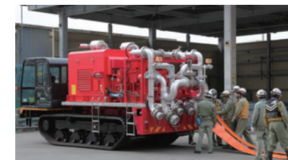
注水機能の喪失を想定した可搬式注水ポンプを用いた訓練
