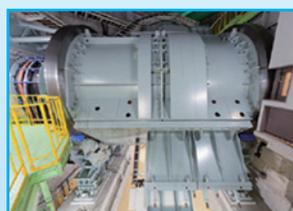
陽子線をどの方向からも自在に高精度照射するための回転装置(重さ約200トン)。
