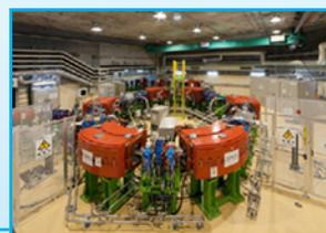
入射器から取り込んだ陽子線を光の速度の60%まで加速する装置。
