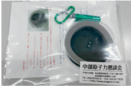
放射線の飛跡を観ることができる《自分で作る『簡易霧箱』》と《大型霧箱》
