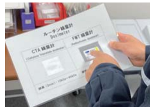
照射線量を評価するため段ボール箱に貼付している線量計
