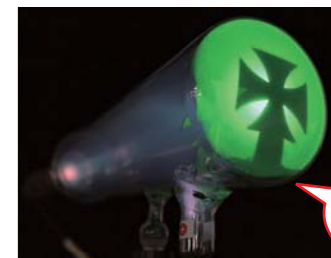
高電圧をかけると光り輝くクルックス管
