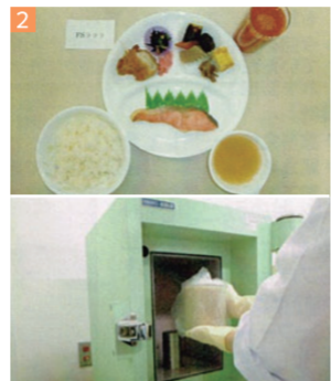
「コブふくしま」が継続的に行った陰膳方式による家庭の食料の放射性物質検査。食品を粉砕して精密な検出器で測定し、安全性を確認
